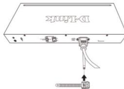
Figura 2-3. Deslize o retentor através da braçadeira
