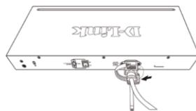
Figura 2-4. Circule em torno do cabo de alimentação
