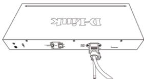
图 2-5. 确保电源线不会脱落
