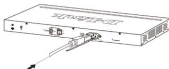
Figura 2-2. Conecte o cabo de alimentação no switch
