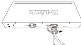
Abbildung 2-4. Stromkabel umwickeln
