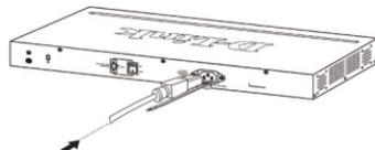
Figura 2-2. Collegamento del cavo di alimentazione allo switch
