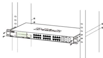
Figura 4. Instalar el switch en un rack estándar
