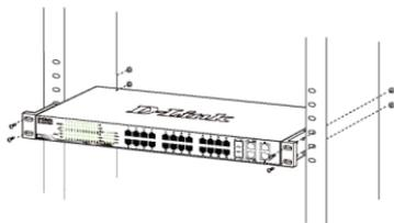
Figure 4. Installation du switch dans une armoire de taille standard
