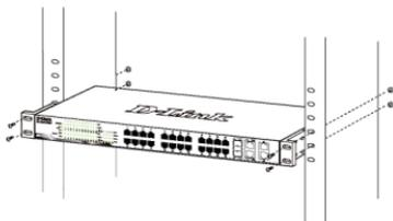
Abbildung 4: Switch im Standardrack installieren
