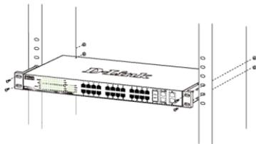
圖 4. 安裝交換器到標準尺寸的機架
