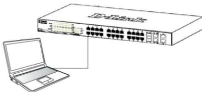
Figure 6. Branchement du câble Ethernet
