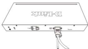
Figura 2-5. Fissaggio del cavo di alimentazione
