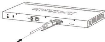
Figure 2-2. Connectez le cordon d'alimentation au commutateur.
