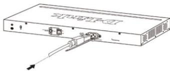
圖 2-2. 將電源線連接至交換器
