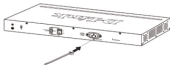
図 2-1. スイッチにタイラップを挿入する
