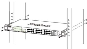
Gambar 4. Memasang switch ke rak dengan ukuran standar
