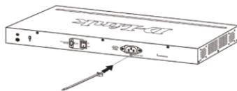
Figure 2-1. Insérez le collier de serrage dans le commutateur
