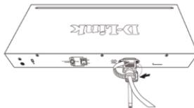
Figura 2-4. Avvolgimento della fascetta intorno al cavo di alimentazione
