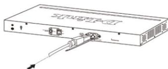
Figure 2-2. Conecte el cable de alimentación al Switch
