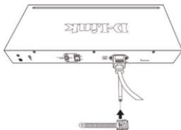
图 2-3. 将扎带一头插入固定好的扎带上
