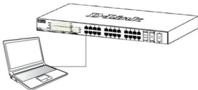
图 6. 连接以太网线
