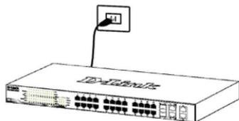
Рисунок 5. Подключение коммутатора к розетке
