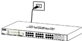
Figura 5. Conectar el switch a una toma eléctrica
