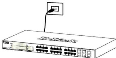
圖 5. 將交換器電源插上牆壁插座
