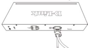
Abbildung 2-5. Stromkabel sicher befestigen
