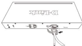
图 2-4. 将扎带环绕在电源线上
