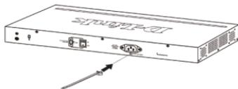
Рис. 2-1. Установка кабельной стяжки на коммутатор
