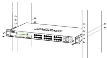
Figura 4. Installazione dello switch all'interno del rack
