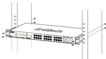
图 4. 安装交换机到标准尺寸的机架
