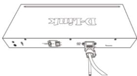
Gambar 2-5. Kencangkan ikatan kabel daya
