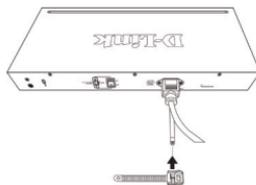
Abbildung 2-3. Kabelhalter durch den Kabelbinder führen
