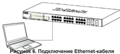
Рисунок 6. Подключение Ethernet-кабеля
