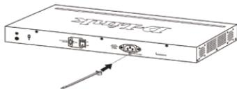
图 2-1. 将扎带插到交换机上的小孔中
