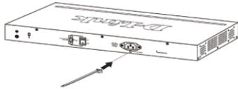
圖 2-1. 將固定帶插入交換器
