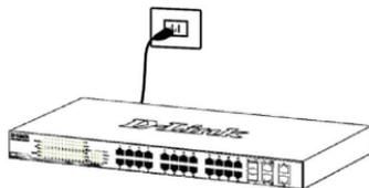
Figura 5. Collegamento dello switch alla presa di corrente
