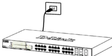
Abbildung 5: Switch an die Stromversorgung anschließen
