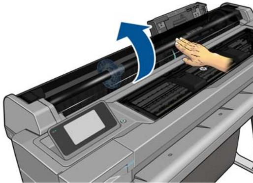
3. Setzen Sie die Spindel in den Drucker ein. Halten Sie sie dabei an beiden Enden fest. Der blaue Anschlag muss, von der Vorderseite des Druckers aus betrachtet, nach links zeigen.
