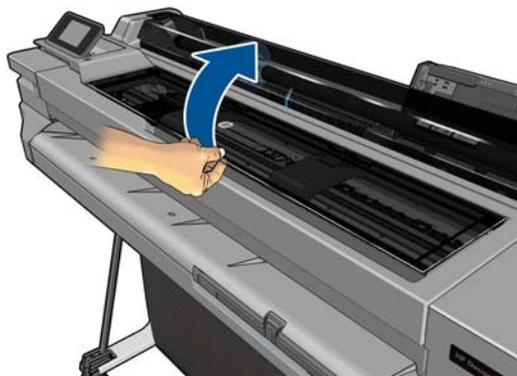
**11.** Levante la palanca del carro.
