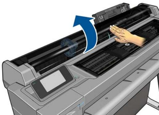
3. Inserte el eje en la impresora, sosteniéndolo por los dos extremos. El disco azul debe quedar a la izquierda, mirando desde la parte delantera de la impresora.
