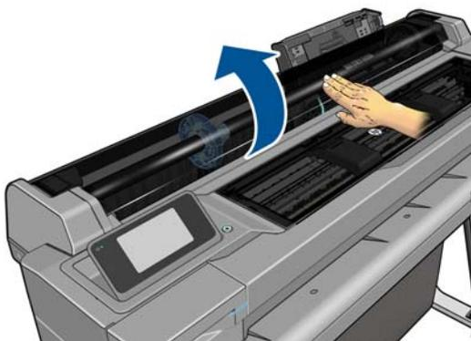
3. Insérez la bobine dans l'imprimante à la tenant par ses extrémités. Le moyeu bleu devrait être situé à gauche, vu de l'avant de l'imprimante.
