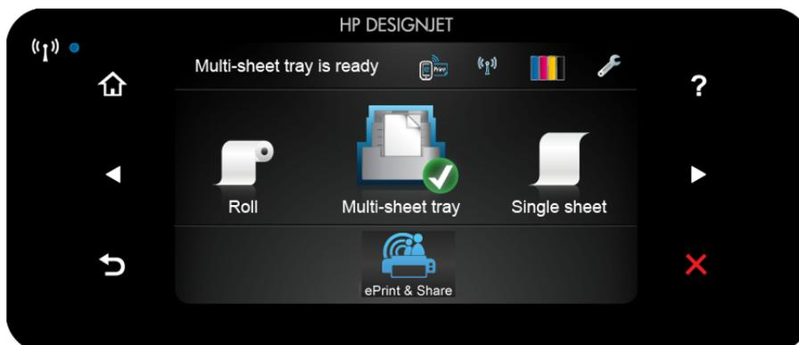
На передней панели большая центральная область отображает значки и графики. В левой и правой частях в различное время могут отображаться до шести фиксированных значков. Обычно они не отображаются одновременно.
