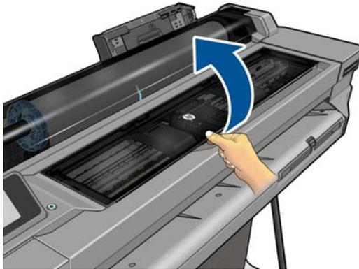
2. 嘗試將印字頭托架移開。
