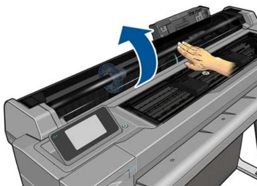
3. 握住捲軸的兩端，將捲軸插入印表機。若從印表機正面看，藍色輪軸應該在左邊。
